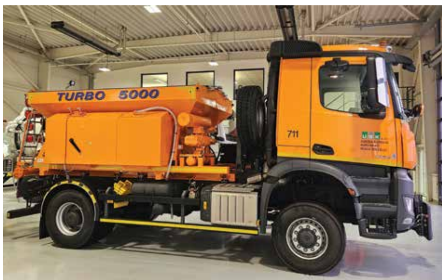
Nákladní vozidlo Mercedes Benz Arocs 1836 se zimní nástavbou Schmidt Stratos MS 34 a pluh Tarron MS 34 s letní nástavbou Turbo 5000 pro středisko Bělá pod Bezdězem
